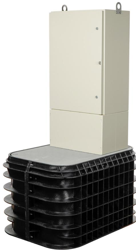
El gabinete de empalme del concentrador de distribución de fibra Optimus (OCSH) es una solución de concentrador de distribución de fibra de alta densidad, montado en bóveda, diseñada para arquitecturas de implementación FTTX divididas centralizadas. El OCSH cuenta con una robusta carcasa de aluminio con recubrimiento en polvo que admite hasta 288 F en un espacio compacto y permite a los operadores adaptar el gabinete al diseño de su red, maximizando así el retorno de la inversión.
