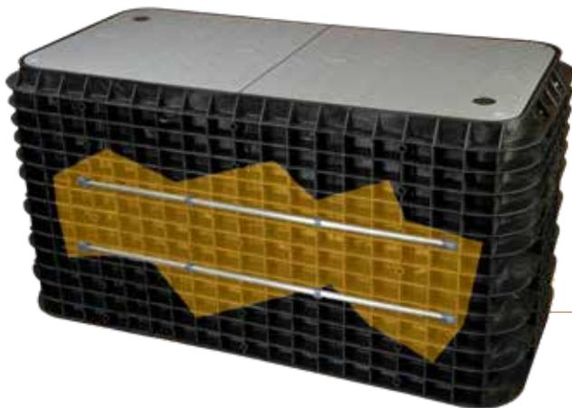
El tubo de acero inoxidable está construido en la pared lateral de la fosa para evitar la deflexión de la pared lateral en cajas BULK de 24" (610 mm) y más profundas.
