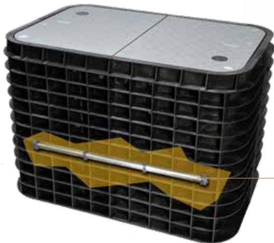
El tubo de acero inoxidable está construido en la pared lateral de la fosa para evitar la deflexión de la pared lateral en cajas BULK de 24" (610 mm) y más profundas.
